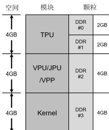
图 6-1 SE6 算力核心板内存分配图
