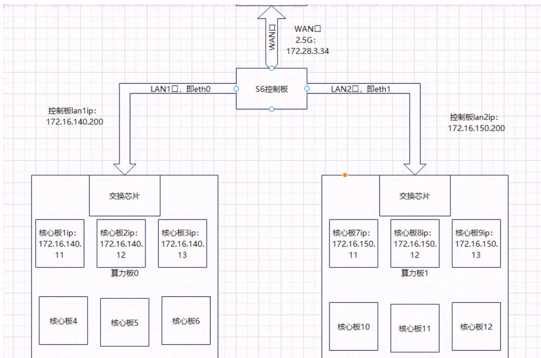
SE6 由一个控制板和两个算力板组成，每个算力板由 6 个算力核心板组成。一共 12 块算力核心板和一个控制板。控制板有 3 个网口：enp3s0（即 WAN），eth0（即 LAN1），eth1（即 LAN2）。
